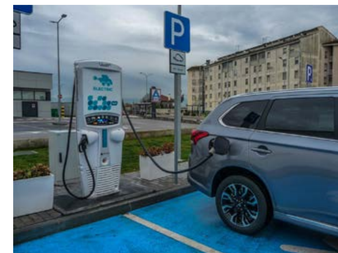
PCR só com DC, CHAdeMO e CCS a 50 kW.
