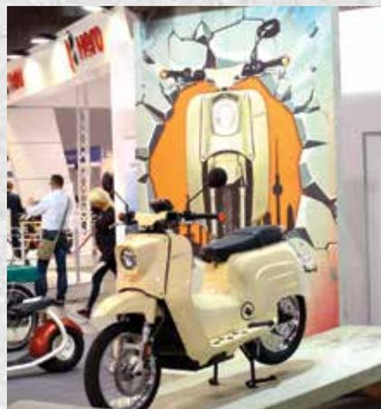
A Govecs Schwalbe conta com uma bateria de íões de lítio, que, em função da opção, proporciona uma autonomia entre os 60 e os 180 quilómetros. As baterias foram instaladas nas partes laterais da 'scooter', por baixo do assento. O lançamento comercial está previsto para o segundo semestre, com preços, na Alemanha, que se situam entre os 4.699 euros, para a versão mais económica, e os 5.799 euros para a versão de 6 kW.
