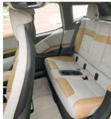
Os estofos, por sua vez, possuem revestimento em lã 'Climate Active', que oferece um equilíbrio positivo entre a temperatura do corpo e a superfície dos bancos, aquecendo menos a temperaturas elevadas e mais a temperaturas baixas. Esta solução engenhosa permite economizar energia no arrefecimento ou aquecimento do habitáculo.
