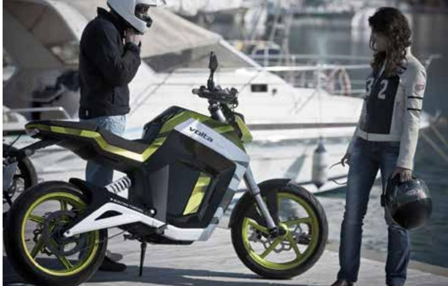
equipadas com um motor elétrico de 25 kW de potência, que permite atingir uma velocidade máxima de 120 km/h. A bateria de iões de lítio proporciona uma autonomia de 70 quilómetros. O tempo de carga é de duas horas numa tomada doméstica de 220 V. As primeiras unidades começam a ser comercializadas no mês de junho e a marca espanhola já tem um distribuidor em Portugal, a Zevtech.
