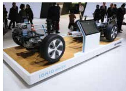
ciada é de 165 km/h. O carregamento de 80 por cento da capacidade da bateria demora cerca de 24 minutos, utilizando um carregador rápido de 100 kW. Uma caixa de controlo com cabo integrado (ICCB) permite também que o utilizador carregue o veículo a partir de uma tomada doméstica normal.
