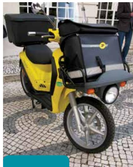
possível carregar até 80 por cento da capacidade das duas baterias em aproximadamente duas horas. Esta e-scooter permite ainda fazer marcha-atrás, o que constitui uma vantagem operacional com o veículo carregado. Está disponível a partir de aproximadamente cinco mil euros. Além da caixa de carga, a Piaggio também propõe, em opção, um pára-brisas e uma proteção para as pernas.
